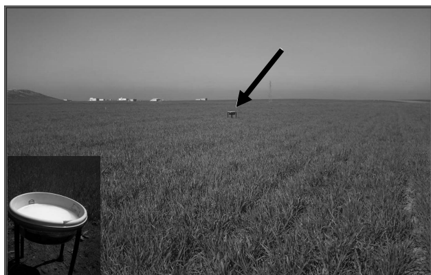
شكل 1. المصائد المائية المستخدمة في جمع حشرات المنّ المجنحة من حقول الشعير والقمح، سورية. Figure 1. Water trap used to collect winged aphids in barley and wheat fields, Syria.
