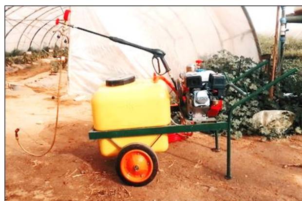
شكل 1. المرشحة الزراعية المقطورة المزودة بمحرك. Figure 1. Motorized trailer agricultural sprayer.
